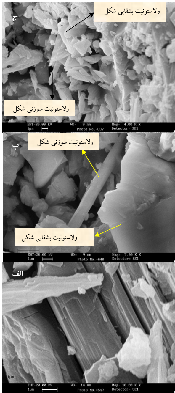
شکل (۱۱): تصویر SEM نمونه پخت شده در ۱۳۰۰ درجه سانتی گراد با نسبت مولی C/S برابر با یک یا بزرگنمایی الف) ۱۰۰۰۰ برابر، ب) ۷۰۰۰ برابر و ج) ۴۰۰۰ برابر.
