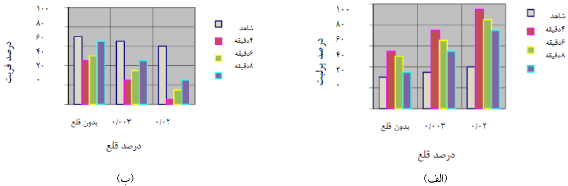
شکل (۱۱): تأثیر زمان خروج قطعات از قالب‌ها بر میزان (الف) پرفیت و (ب) فریت قطعات چدن نشکن ریختگی.
