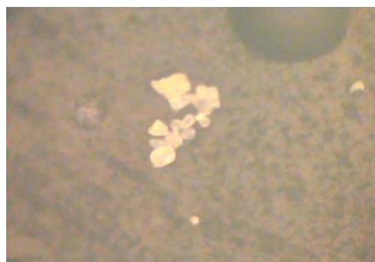
شکل (۸): نتایج میکروسکوپی پودر W نزدیک به انتهای کوره در بزرگ نمایی ۴۰۰X
