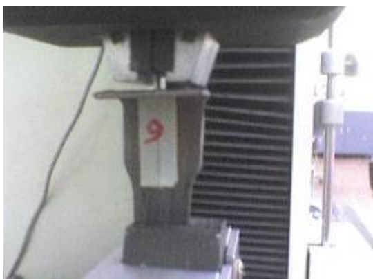
شکل (۲): نحوه بستن نمونه به فک دستگاه برای انجام آزمون Pull-Out.
