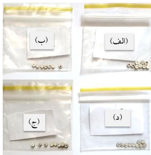
شکل (۲): نمونه‌های PZT5 به همراه افزودنی‌های کبالت و مولیبدن: (الف) بدون افزودنی، (ب) با ۰/۰۲ مول Co، (ج) با ۰/۰۲ مول Co و ۰/۰۲ مول Mo و (د) با ۰/۰۲ مول Co و ۰/۰۱ درصد مول Mo.
