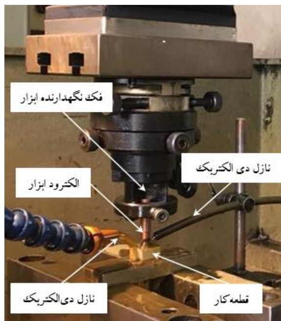
شکل (2): نمایی از فرایند ماشین کاری تخلیه الکتریکی و نحوه اعمال سیال دی الکتریک (بدون حضور میدان مغناطیسی).
