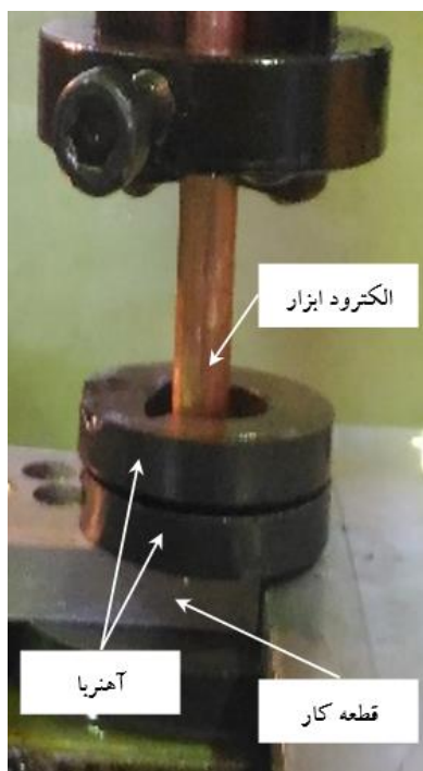
شکل (3): نحوه قرار گرفتن آهنرباها در اطراف محل ماشین کاری تخلیه الکتریکی جهت ایجاد میدان مغناطیسی.
