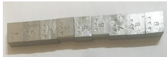
شکل (۱): قطعات مکعبی برش داده شده جهت انجام آزمایش‌ها
