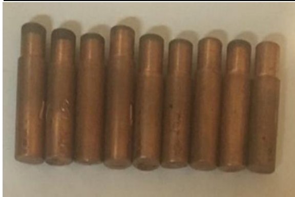
شکل (۲): الکترودهای مسی مورد استفاده در ماشین کاری تخلیه
