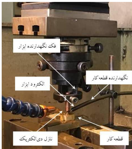
شکل (۳): نمایی از فرآیند ماشین کاری تخلیه الکتریکی انجام شده در
