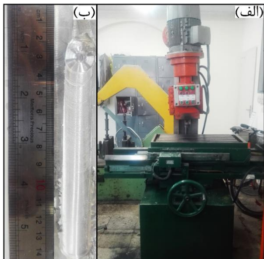
شکل (۱): (الف): تصویر دستگاه جوشکاری اصطکاکی هم‌زدنی. (ب): آلیاژ منیزیم AZ91 یک پاس فرآیند شده.
