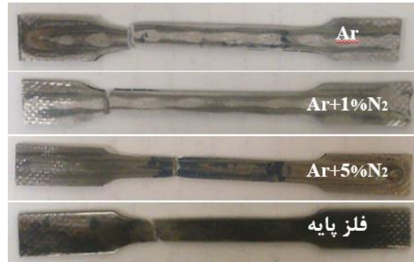
شکل (۷): تصاویر محل شکست نمونه‌های کشش پس از انجام آزمون.
