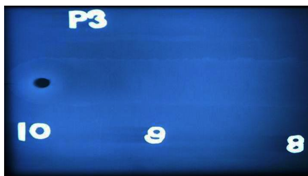
شکل (۵): نمونه جوش سالم در نواحی مختلف حاصل جوش اصطکاکی اغتشاشی تولید شده با پارامترهای بهینه
