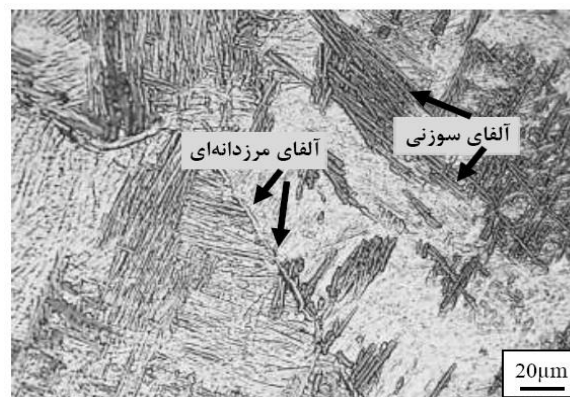
شکل (۲): ریزساختار شمش آلیاژ SP-700 پس از آنیل در دمای 850^{\circ}\text{C} به مدت یک ساعت و سرمایش در آب
