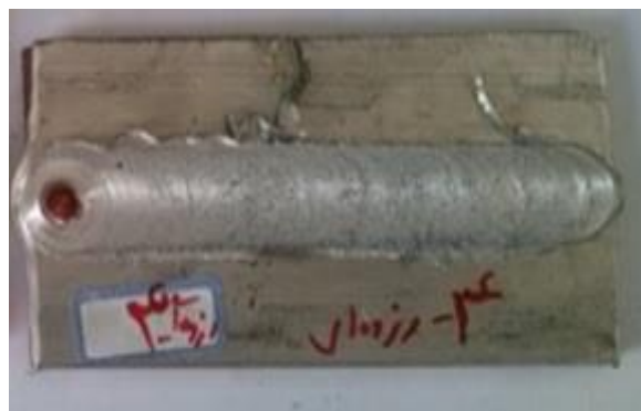
شکل (۳): جریان سطحی اتصالی که در سرعت دورانی ۱۱۳۰ دور بر دقیقه و سرعت خطی ۲۴ میلیمتر بر دقیقه جوشکاری شد
