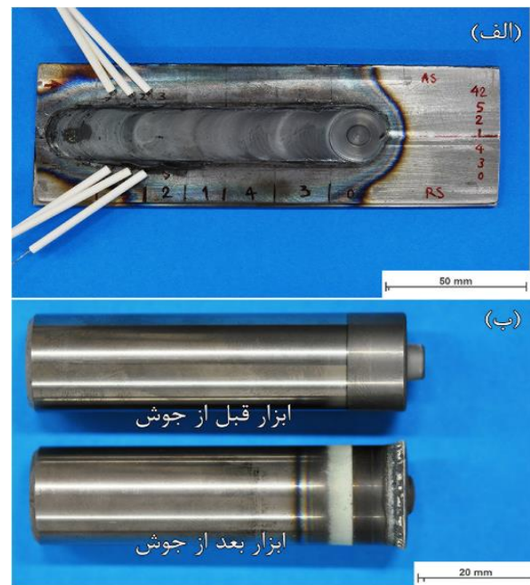
شکل (۳): (الف): ظاهر سالم جوش FSW و (ب): ابزار قبل و بعد از فرایند FSW
