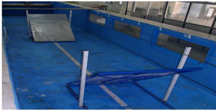
شکل 1- نمای مخزن آزمایشگاهی موج برای شبیه سازی امواج ضربه ای ناشی از لغزش دیواره (عطایی آشتیانی و نجفی جیلانی، 2008)
