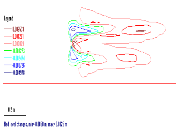
شکل ۹- فرسایش پایه پل پس از گذشت مدت زمان ۷ ساعت (شکاف مجاور سطح آب)
