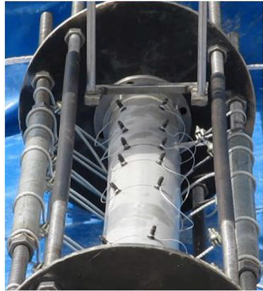
شکل ۱۲ مجموعه سازه آزمایش رشد سریع ترک به همراه کلیه اجزاء مربوطه نصب شده
