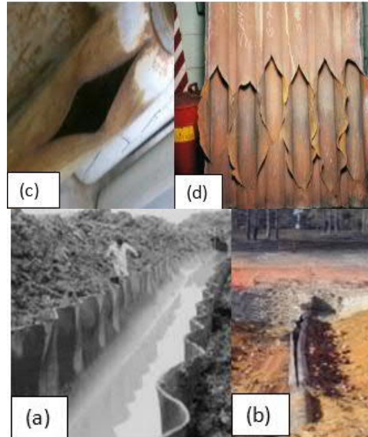
شکل ۲ پدیده رشد سریع ترک ناشی از ترکیدگی (الف) لوله فولادی انتقال گاز (ب) لوله فولادی انتقال نفت (ج) کپسول نیتروژن در حین شارژ (د) خط انتقال بخار در نیروگاه
