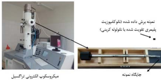
شکل ۱ نحوه قرارگیری نمونه برش داده شده در میکروسکوپ الکترونی تراگسیل
