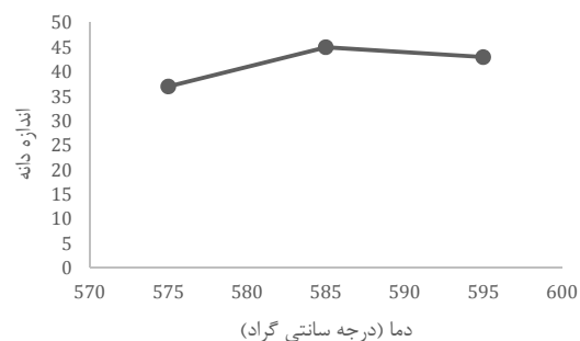
نمودار ۱ تغییرات اندازه دانه بر حسب دما، برای نمونه‌های تیگزوفورج شده آلیاژ A356
