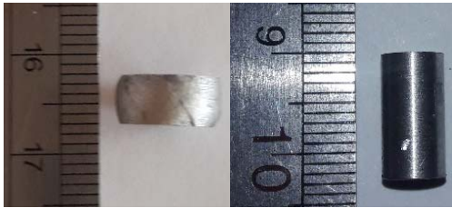
شکل ۷ نمونه‌های ماشین‌کاری شده و تغییر شکل یافته بعد از آزمون فشار
