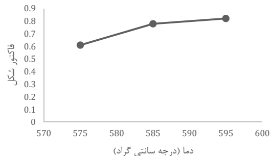
نمودار ۲ تغییرات فاکتور شکل (میزان کرویت) بر حسب دما برای نمونه‌های تیگزوفورج شده آلیاژ A356
