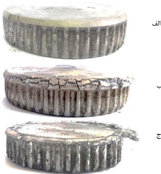
شکل ۴ نمونه‌های تیگزوفورج‌شده در دمای (الف) ۵۷۵ (ب) ۵۸۵ (ج) ۵۹۵ درجه سانتی‌گراد
