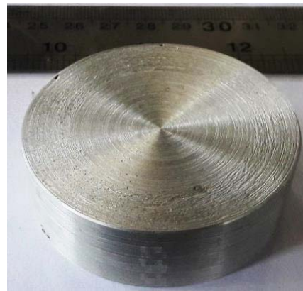
شکل ۳ بیلت ریخته‌گری شده روی سطح شیب‌دار و ماشین‌کاری شده
