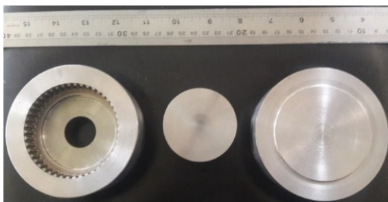
شکل ۱ از چپ به راست ماتریس، میل پران و سنبه
