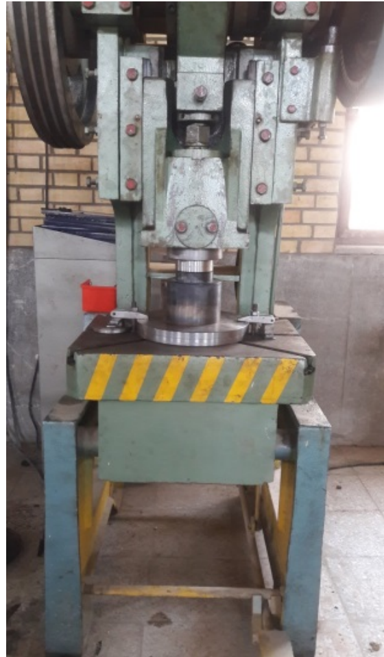
شکل ۲ مجموعه مونتاژ شده قالب روی پرس
