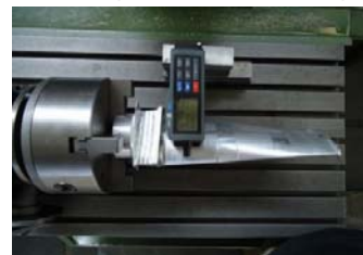
شکل ۷ موقعیت قرار گرفتن دستگاه زبری سنج
