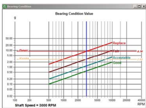
شکل ۲ استاندارد خرابی یاتاقان‌های غلتکی بر حسب g [۲۳]
