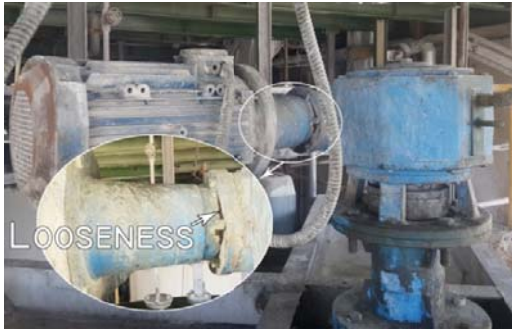
شکل ۱۳ مشخص کردن محل لقی در واسطه نگهدارنده الکتروموتور
