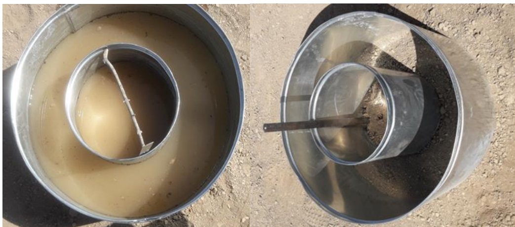
شکل ۲. حلقه‌های مضاعف برای اندازه‌گیری نفوذ آب به خاک
