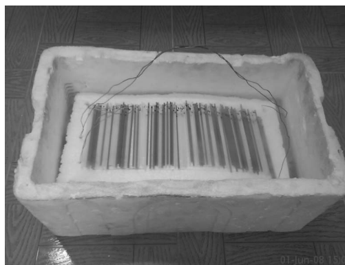
شکل ۳- سرمادهی تدریجی توسط بخار ازت مایع
