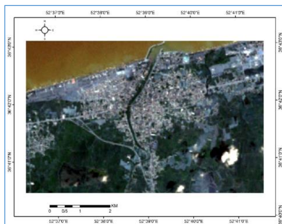
شکل ۱۰. نقشه NDBI باند آبی و باند حرارتی و نقشه Stacking سال ۱۹۹۹ با ترکیب رنگی مادون قرمز نزدیک، قرمز و سبز
