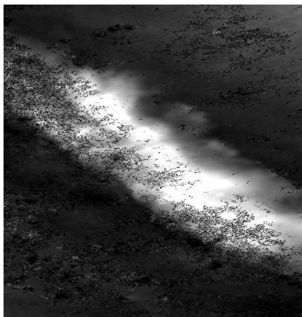
شکل ۲۰. تصحیح فاز بر روی زوج تصاویر استفاده شده از ماهواره Sentinel-1
