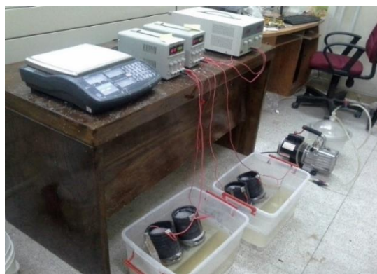
شکل ۳. نمایی از آزمایش انتشار تسریع شده یون کلراید
