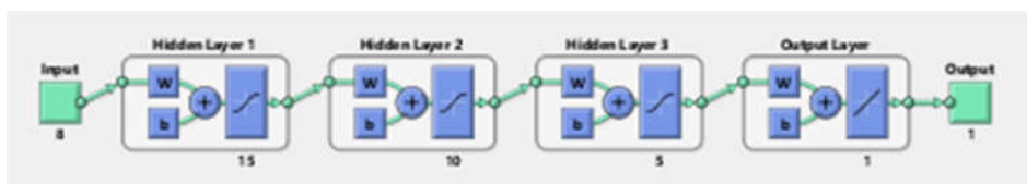
شکل ۷- شمای کلی شبکه عصبی چند لایه آموزش داده شده بر روی مجموعه داده
