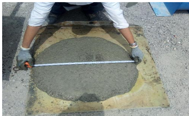
شکل ۴ - آزمایش جریان اسلامپ
