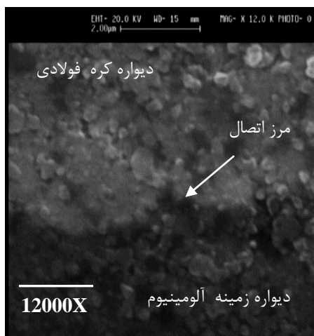
شکل ۲- تصویر محل اتصال دیواره کره های توخالی فولادی و زمینه آلومینیومی.
