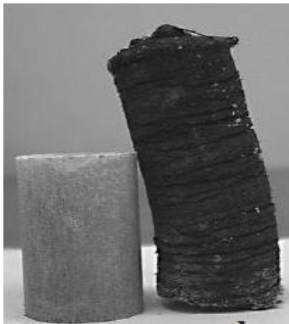
شکل ۱- ایجاد اعوجاج و تخلخل در فرآورده‌های ناشی از سنتز احتراقی (سمت راست)، قطعه خام فشرده شده (سمت چپ) در اثر واکنش‌های گرمازای شدید و خروج گاز و ناخالصی‌ها.
