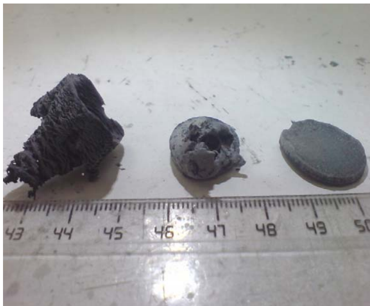
شکل ۴- تصاویر نمونه های سنتز احتراقی شده از راست به چپ حاوی ۳۰، ۲۰ و ۱۰ درصد مواد رقیق کننده از جنس خود فرآورده‌ها ( \text{Al}_2\text{O}_3\text{-TiB}_2 ).
