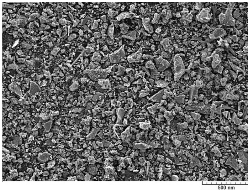
شکل ۴- نگاره میکروسکوپ الکترونی روبشی (SEM) ترکیب آسیاب شده برای ۱۰ ساعت.
