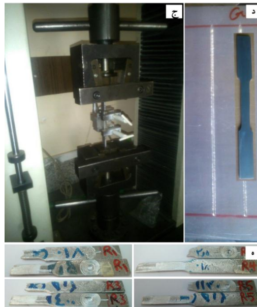
شکل ۳- (الف) دستگاه فرز عمودی مورد استفاده، (ب) ورق آلومینیم شیاردار بسته شده بر روی میز کار دستگاه فرز، (ج) دستگاه آزمون کشش، (د) محل انتخاب نمونه کشش (ه) نمونه های کشش بعد از آزمون
