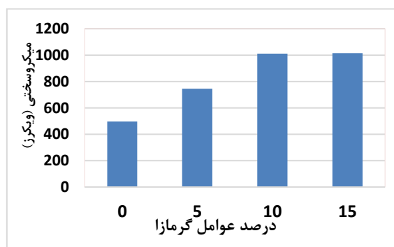
شکل ۶. تغییرات میکروسختی با افزایش درصد فازهای سرامیکی.
