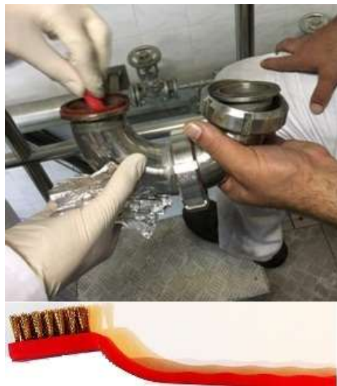
شکل (۱)- روش نمونه‌گیری از تجهیزات فرآوری
