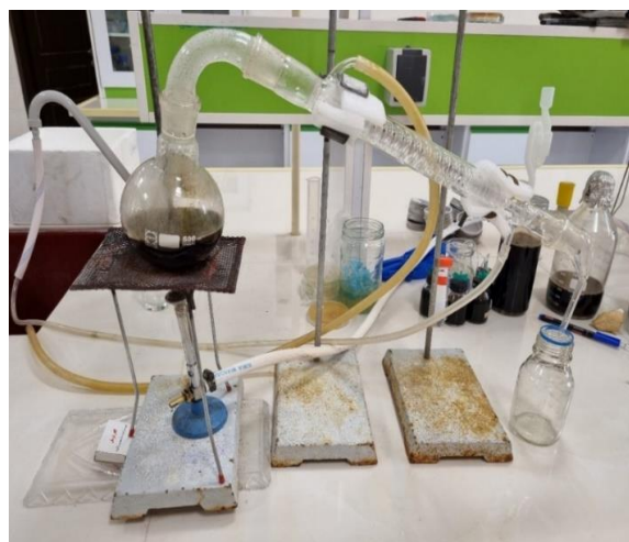
شکل ۲. تقطیر اتانول تولید شده با سیستم تقطیر شیشه ای
