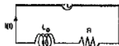
شکل (۳۲): نمایی از سیستم Inductrack و مدل مداری آن [۴۹] Fig. (32): A schematic of Inductrack system and its circuit model [49]
