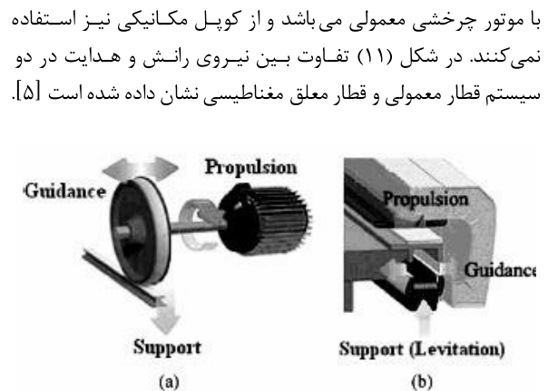
شکل (۱۱): نمایش تفاوت: (a) قطار معمولی با (b) قطار معلق مغناطیسی [۵]
