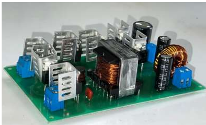
شکل (۸): مبدل پیشنهادی پیاده‌سازی شده در آزمایشگاه
