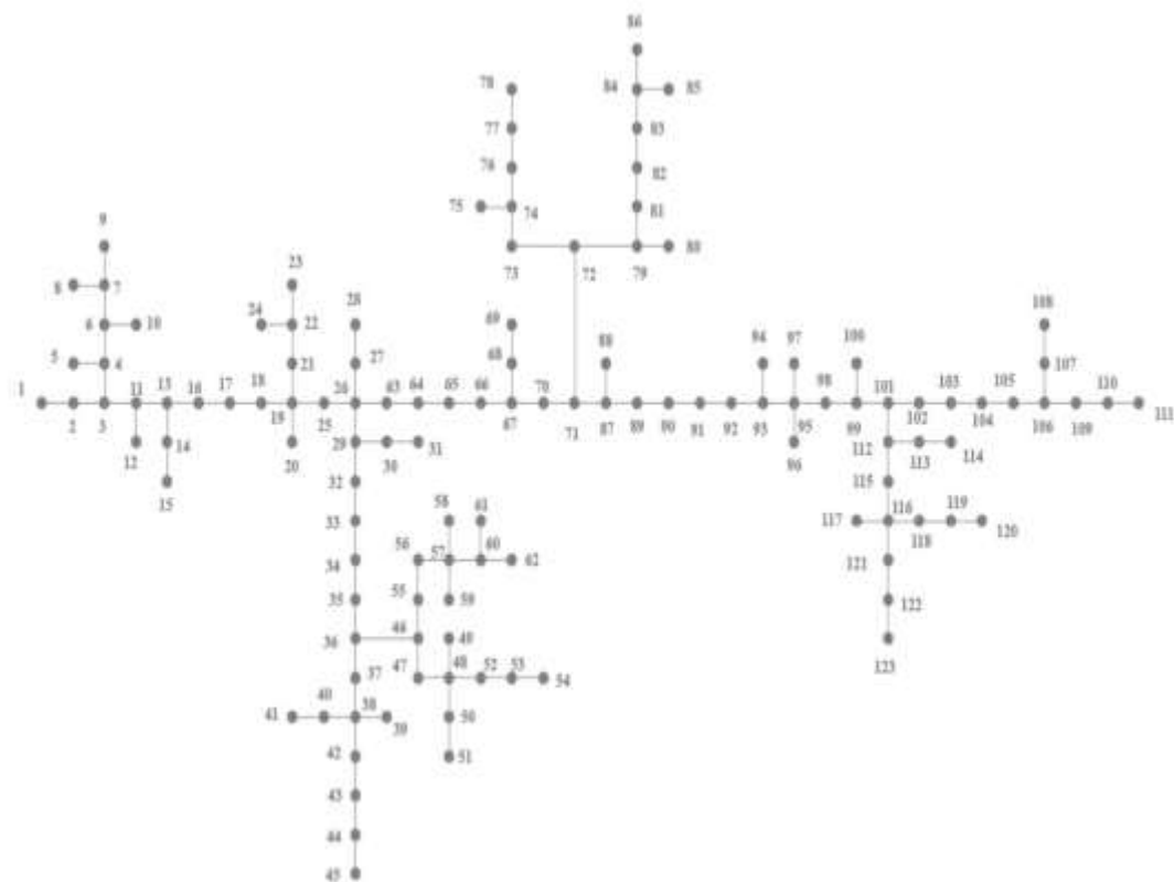
شکل (۶): دیاگرام تک خطی سیستم ۱۲۳ شینه شعاعی عملی [۲۲]
