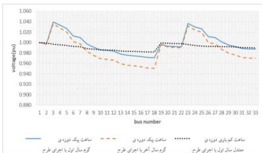
شکل (۱۰): نمودار پروفیل ولتاژ شبکه تست ۳۳ شینه در سناریوی سوم با اجرای طرح مربوط به پاسخ پارتوی دوم
