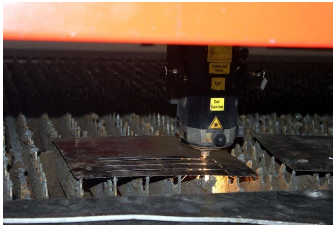
شکل (۲): دستگاه برش لیزری دی اکسید کربن استفاده شده در این پژوهش
