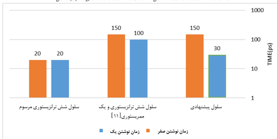
شکل (۶): مقایسه زمان نوشتن صفر و یک روی سلول پیشنهادی و سایر سلول‌ها Figure (6): Comparison of the "0" and "1" write times for the proposed cell with those for other cells
