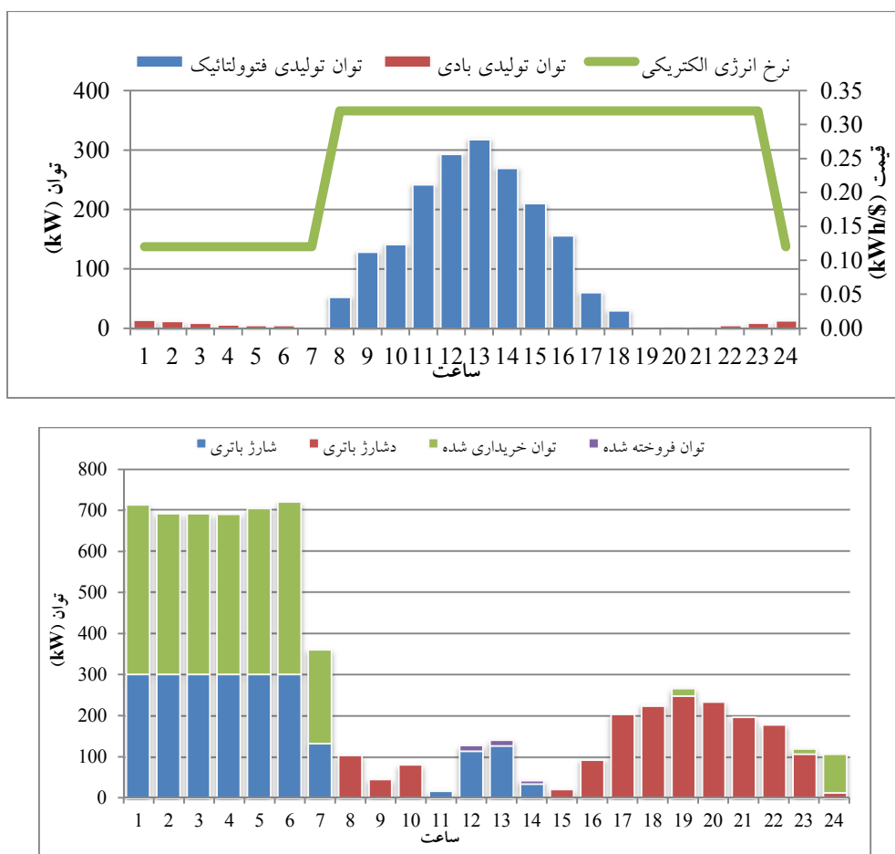
شکل (۷): نمودار توزیع توان در ریزشکبه در سناریو ۱ برای پاسخ‌گویی بار ۰٪ Fig. (7). Power distribution chart in microgrid in state 1 for response 0% load
