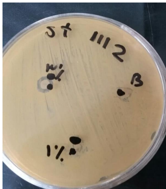
شکل ۶- بررسی خصیبت ضد میکروبی نانوالیاف در غلظت‌های ۰، ۱ و ۳ درصد (w/v) از ماده ضدباکتری اسانس آویشن شیرازی
