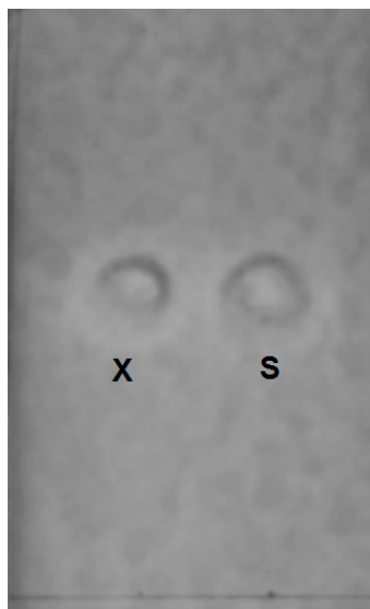
شکل ۳- TLC حاصل از زایلیتول تولید شده (X: زایلیتول شاهد، S: زایلیتول تولید شده توسط مخمر کاندیدا)
