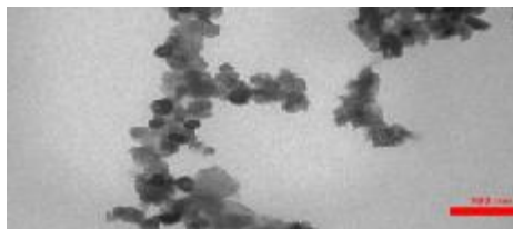
شکل ۴- عکس تهیه شده از نانو ذرات نقره بیوستتز شده با عصاره آبی برگ نعناع توسط میکروسکوپ الکترونی عبوری
