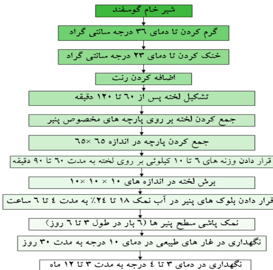
شکل (۱) - دیاگرام تولید پنیر لیقوان به روش سنتی (Shafiei, 2013)
