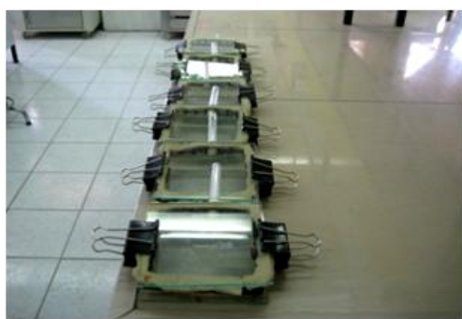
شکل ۱- قفس‌های در معرض قرار دهی برای زیست‌سنجی حشره‌کش‌ها.
