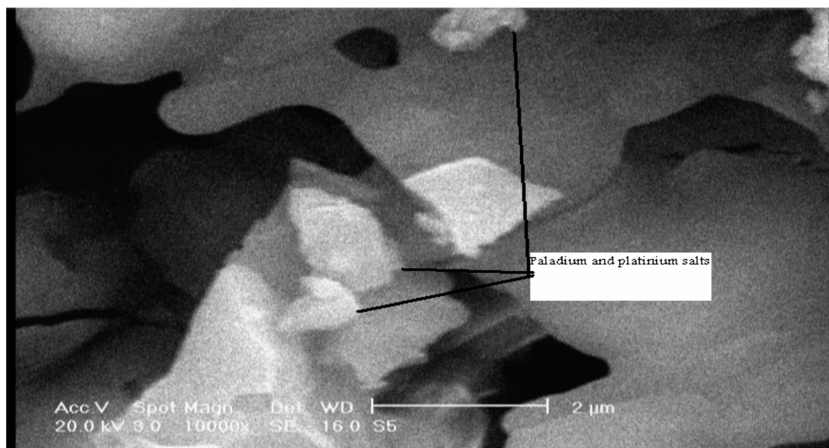
شکل ۸- SEM سطح کاتالیست فعال شده و ذرات Pd, Pt
