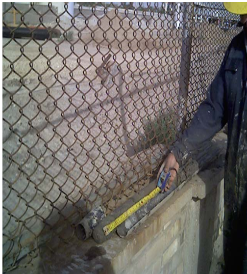
شکل ۷- محاسبه طول مغزه پس از خروج از مغزه گیر.
