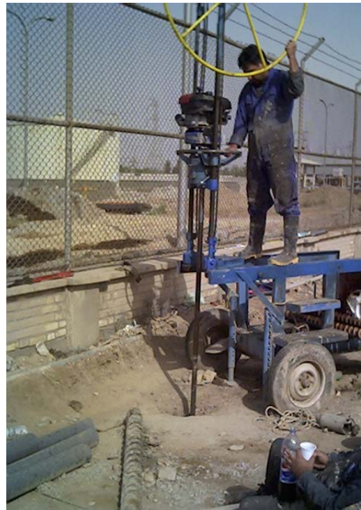
شکل ۵- حفاری در مناطق دلخواه یکی از ویژگی های مهم دستگاه حفاری طراحی شده است.
