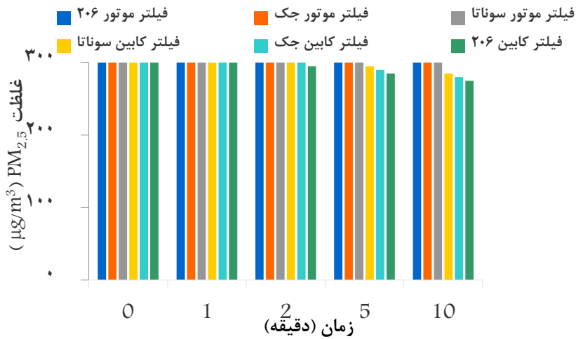
شکل ۴- نمودار غلظت بر حسب زمان برای فیلترهای خودرو
