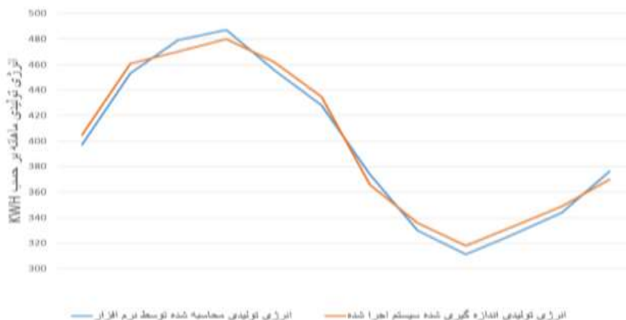
شکل ۳- مقایسه‌ی نتایج حاصل از انرژی تولیدی اندازه‌گیری شده در سیستم اجرا شده و انرژی تولیدی محاسبه شده توسط نرم افزار PVsyst (نگارندگان)
