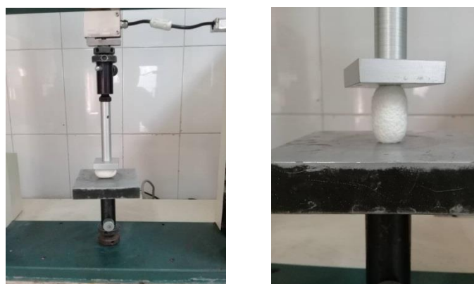
شکل 1. تست مربوط به بارگذاری فشاری نمونه‌های پیله کرم ابریشم
